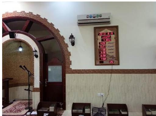
شكل ٥. الساعة الرقمية: ثبتت دون مراعاة لموقعها، وتناسقها مع المحراب، أو طريقة وصلها بالكهرباء (الباحث).
