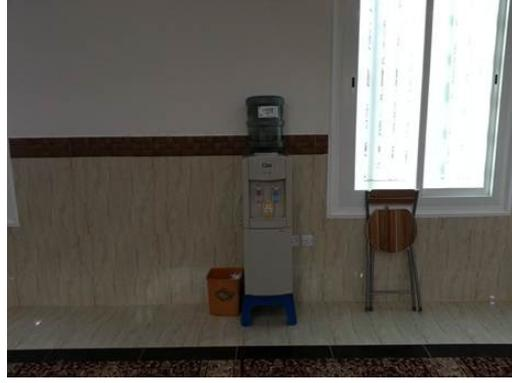
شكل ٧. برادة الماء: لم يكن لها اعتبار في المخططات أو أثناء التنفيذ، وبالتالي أقحمت بعد الافتتاح بجوار أقرب مأخذ كهرباء، ووضح بجانبها وعاء للماء الزائد (الباحث).
